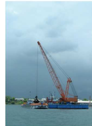
Grue Rapier embarquée à bord du ponton Lislet Geoffroy
