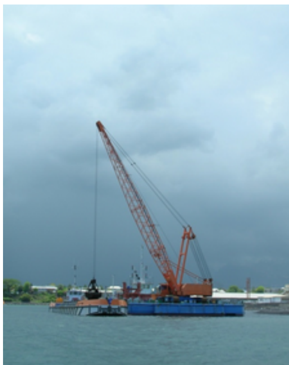
Grue Rapier embarquée à bord du ponton Lislet Geoffroy
